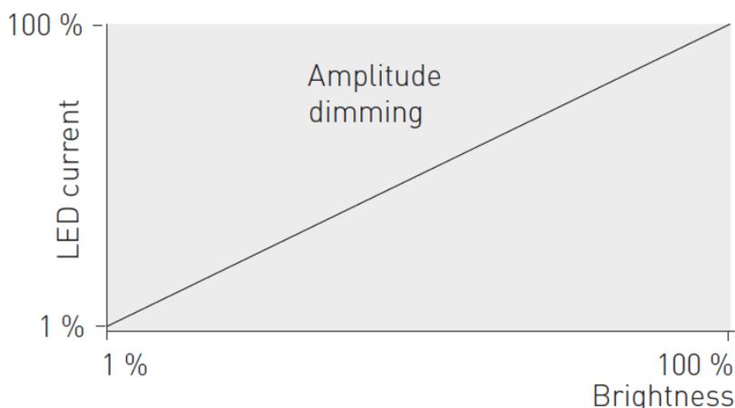
Изменение яркости на всем интервале, от 100% до 1% происходит за счет снижения амплитуды тока. Этот метод диммирования позволяет получить максимально высокое качество света без пульсаций. Драйвер соответствует рекомендациям стандарта IEEE 1789-2015 в отношении модуляции тока для снижения возможных рисков для здоровья человека.
