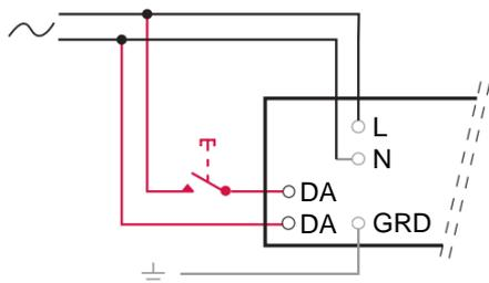
Схема подключения выключателя драйвера в режиме Switch-Control 2.
